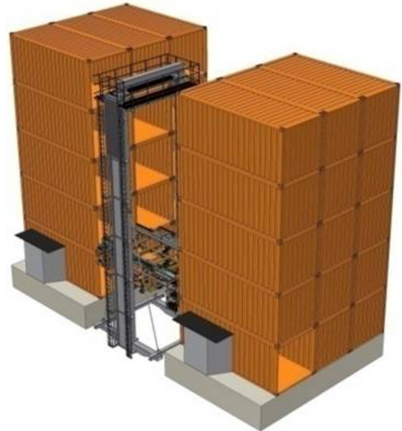
Automatisches Parksystem in Container-Bauweise
